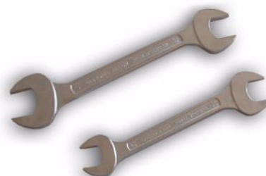
Čeljusni ključ (Broj 27/36) odnosno cijevna kliješta za spoj kolektora
